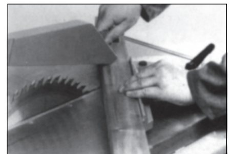
C Winkelanschlag zurückziehen und das Werkstück vorlegen. - Maschine starten.
